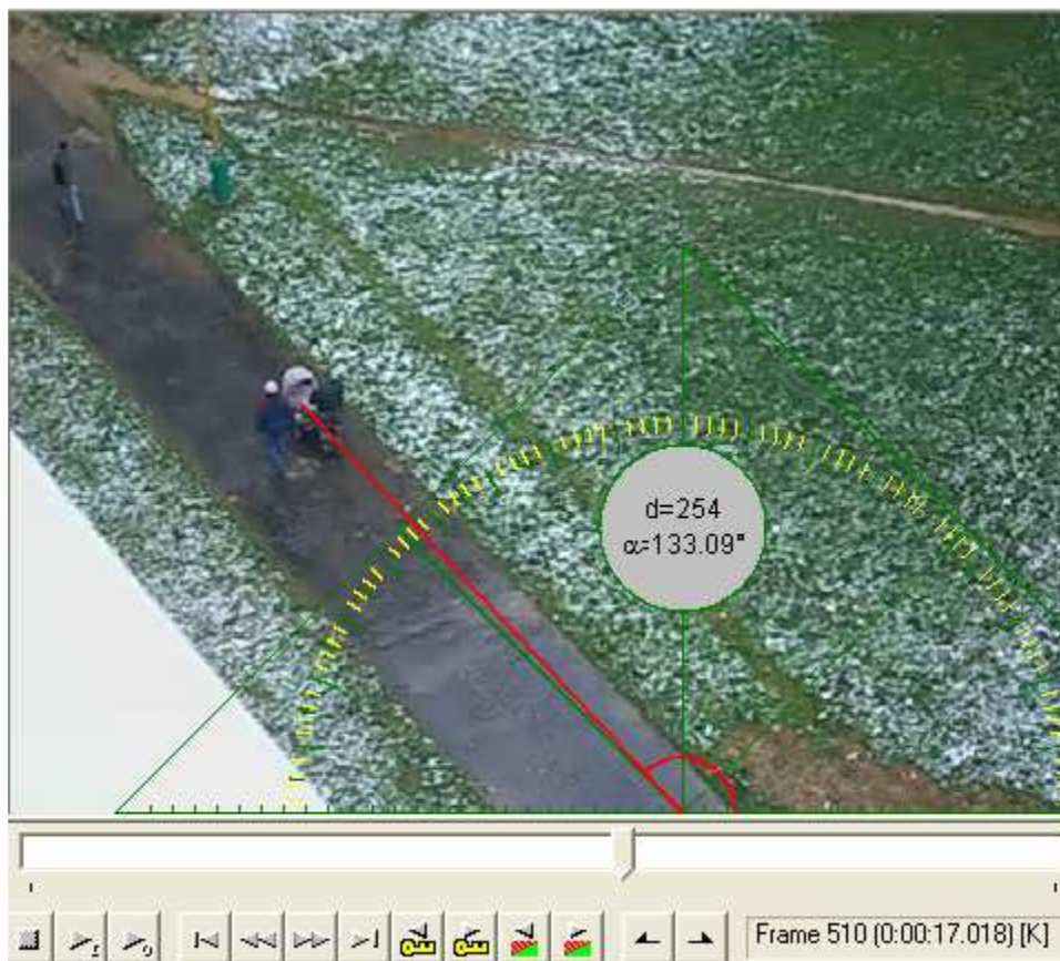
Obrázok 2. Obrázok z videosekvencie reálneho deja v 17,018 sekunde od začiatku deja a určenie vzdialenosti chodcov s kočíkom od istého počiatočného bodu
