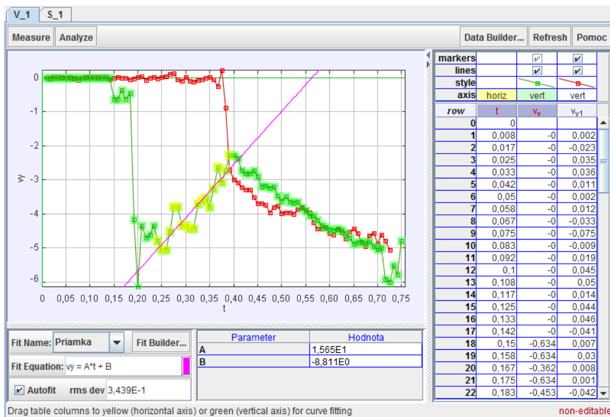
Obr. 7.21 Časová analýza rýchlosti horného konca pružiny (zelená farba) a spodného konca (červená farba)
